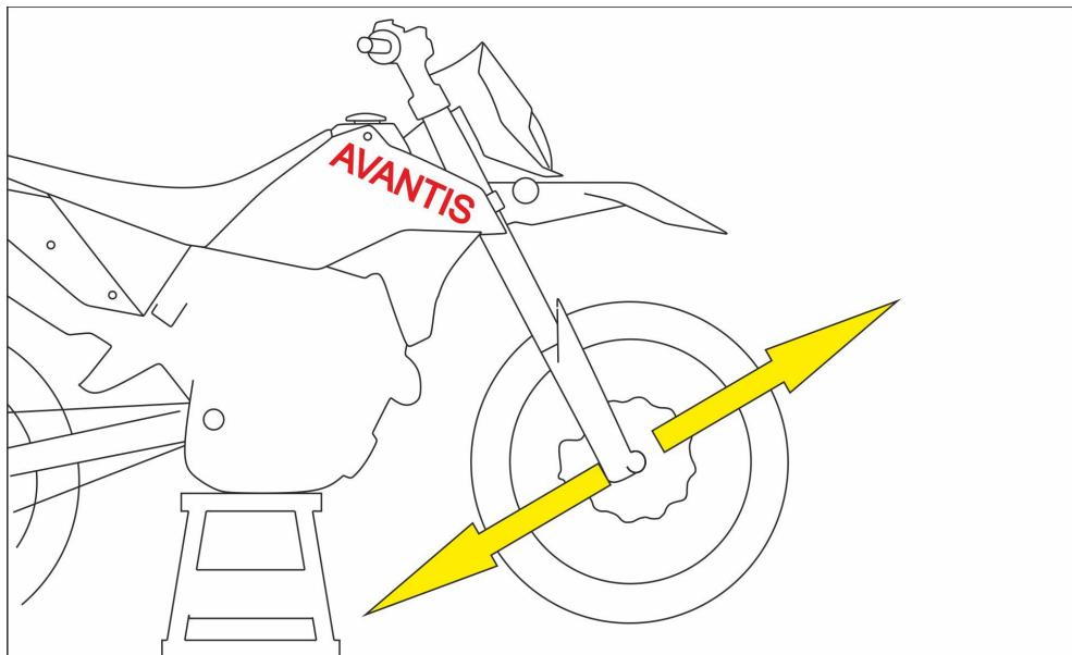
Для регулировки ослабьте болты [1] верхней траверсы и поверните по часовой стрелке гайку [3] до отсутствия свободного хода.
