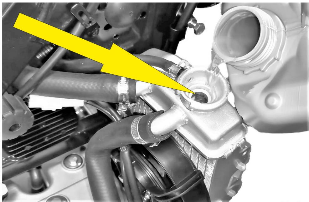
В качестве теплоносителя используется готовый антифриз или смесь; 50% антифриза и 50% дистиллированной воды. Эта смесь обеспечивает защиту от замерзания, а также хорошую защиту от коррозии.
