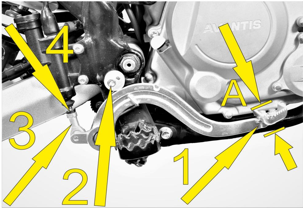
Для регулировки свободного хода, открутите контргайку [3] регулировочного толкателя [2].
